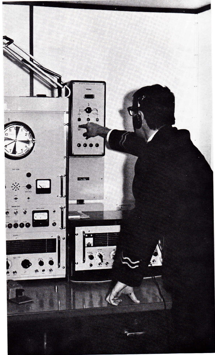
Radio-officier J. Thomas aan boord van de „Neverita” bij de decoder, waarin de oproep wordt omgezet in een belsignaal. Op de tafel daaronder staat de ontvanger, die op het juiste kanaal kan worden afgestemd.
